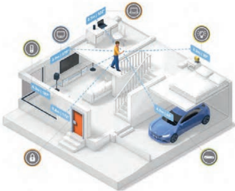
Abbildung 1: NXP Trimension™ - Nutzung der UWB Funktechnologie als Entfernung- und Richtungssensor im Smartphone, Fahrzeug und Internet der Dinge
